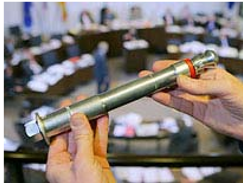
Falsch montierter Dübel Foto: hr-online.de
